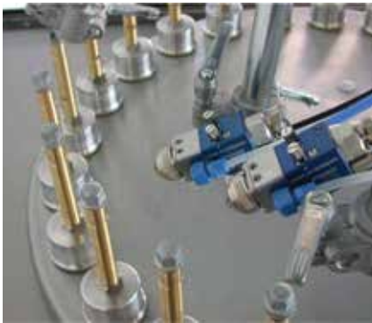
Otomatik boya tabancalarının döner tablalı uygulaması
