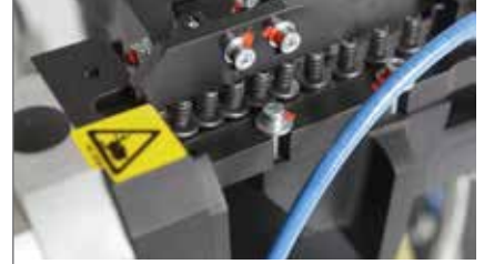
Besleme Ünitesinde Vidaların Dizilimi
