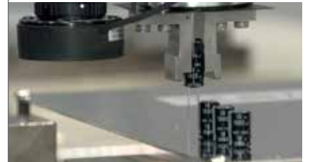
Esnek Tellere Sahip Elektronik Bileşenlerin Yerleştirilmesi
